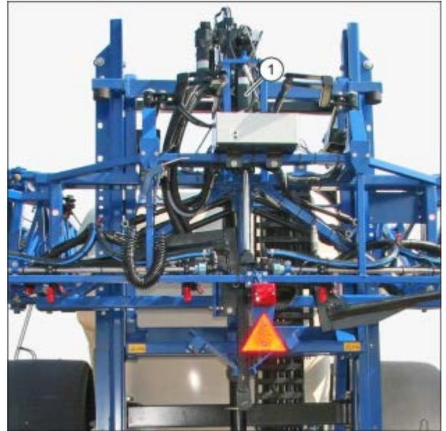
**Abb. 69 Hydraulikzylinder Klappung - Gestänge eingeklappt**
