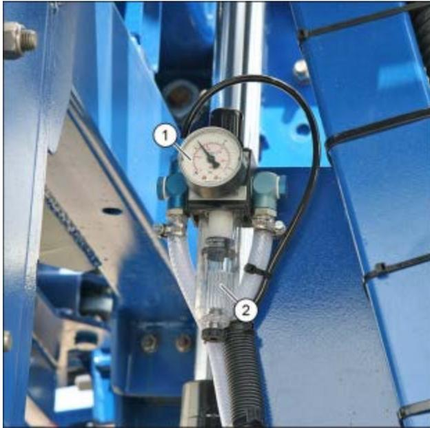
**Abb. 74 Manometer Versorgungsdruck**
