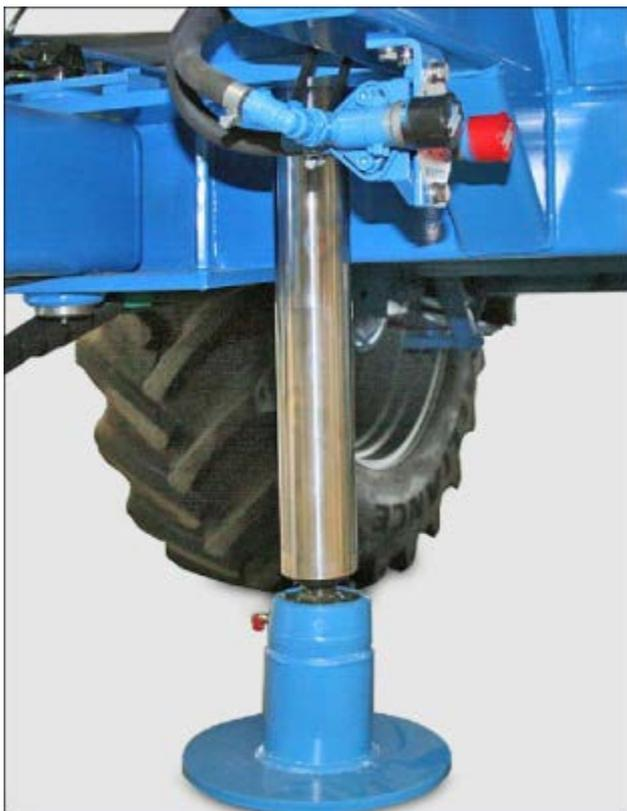
**Abb. 72 Hydraulischer Stützfußzylinder (Option)**
