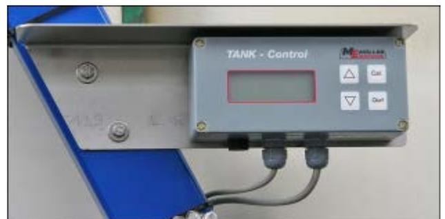
**Abb. 44 Füllstandanzeige Tank-Control**
