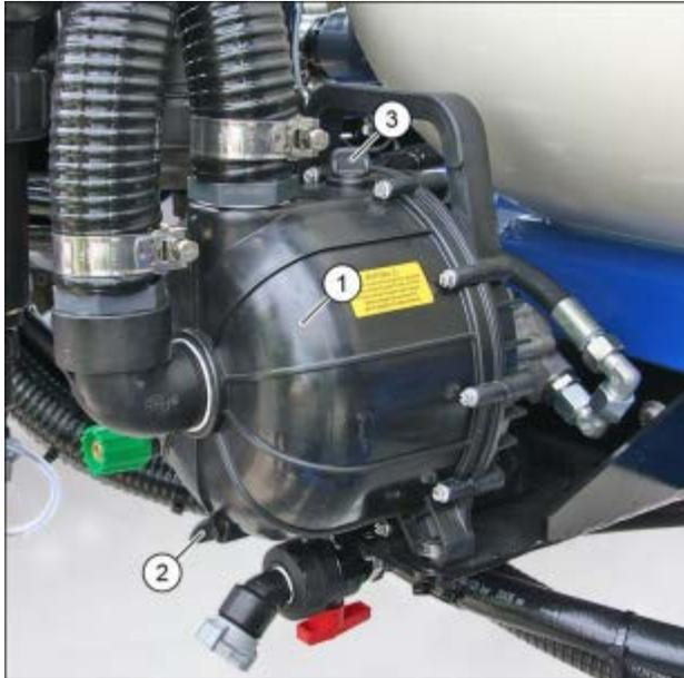
**Abb. 48 Befüllpumpe (Kreiselpumpe)**
