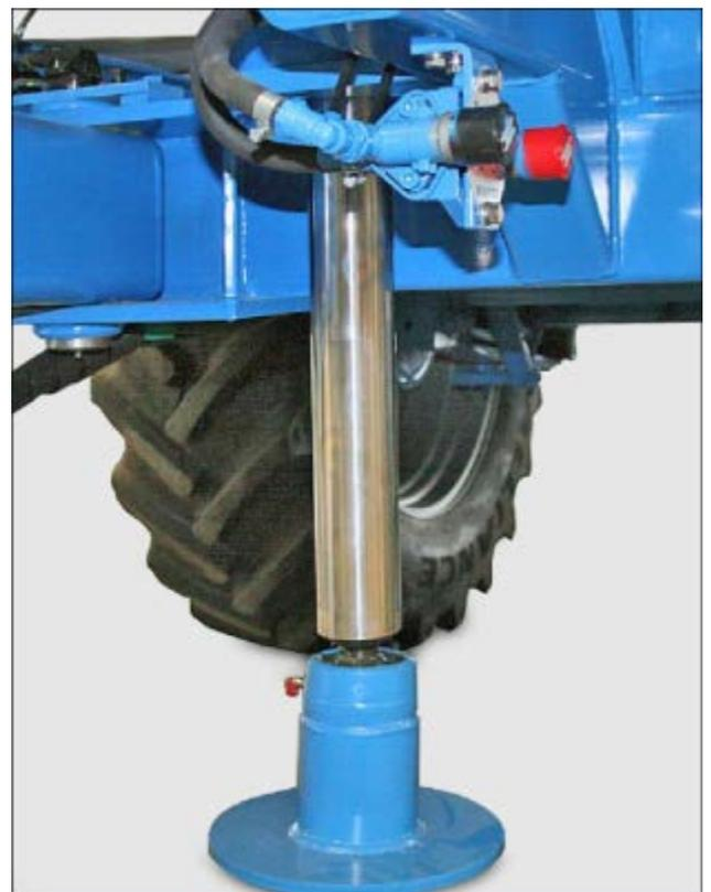
**Abb. 37 Stützfuß hydraulisch bewegbar (Option)**
