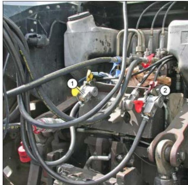
**Abb. 73 Anschluss Druckluft an Zugmaschine**
