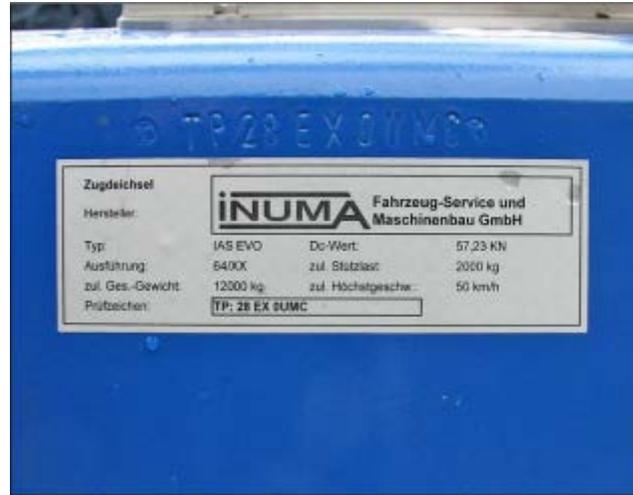
Abb. 16 Typenschild der gelenkten Zugdeichsel
