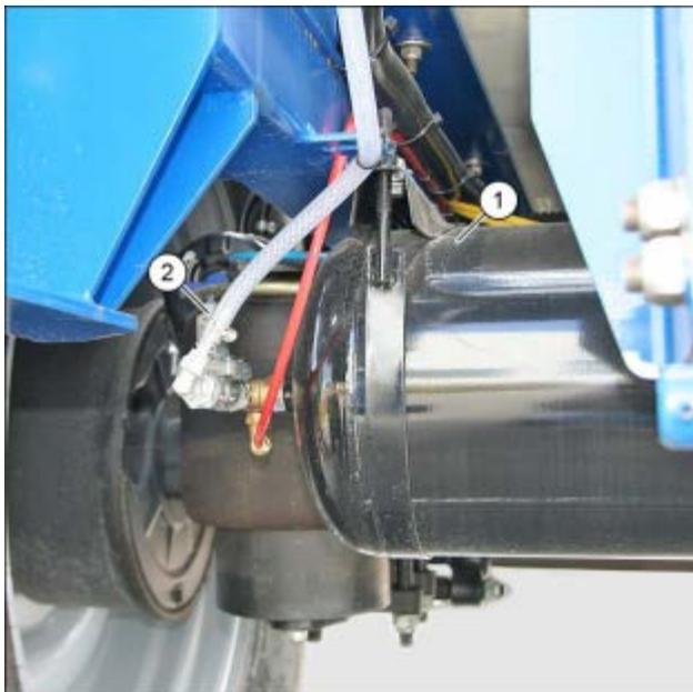
**Abb. 75 Luftkessel**
