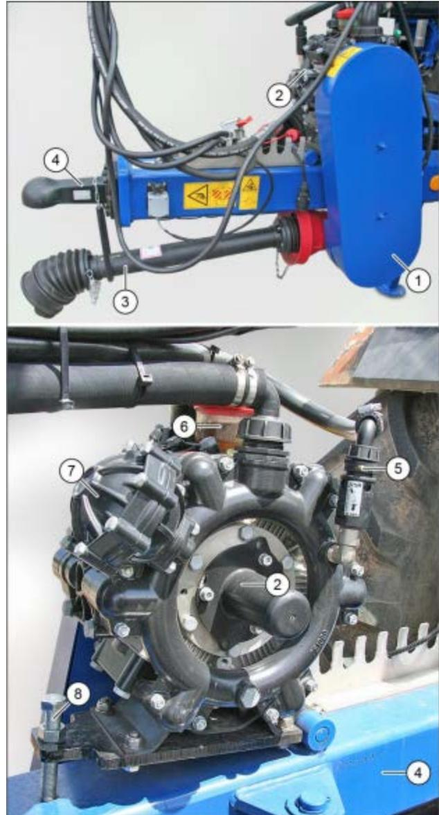
Abb. 47 Spritzpumpe mit mechanischem Antrieb über Gelenkwelle und Keilriemen
