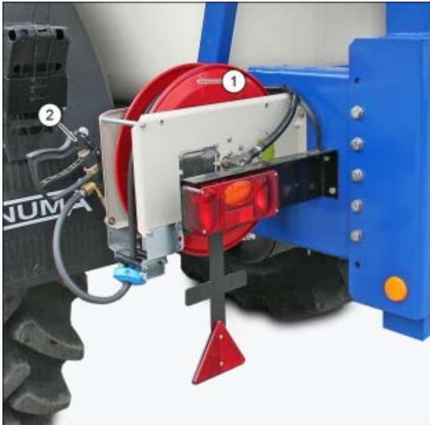
**Abb. 97 Waschtrommel mit Druckleitung**
