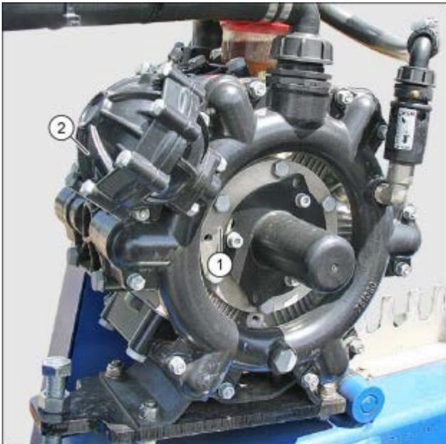
**Abb. 79 Spritzpumpe mit Windkessel**
