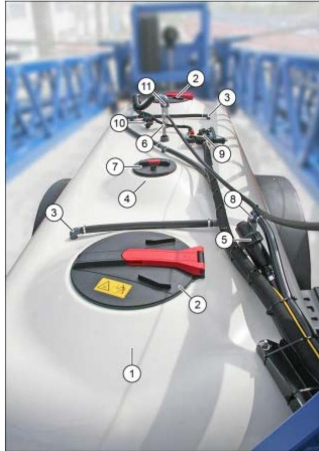
Abb. 41 Spritzmittel- und Frischwasserbehälter Anhängespritze 60XX
