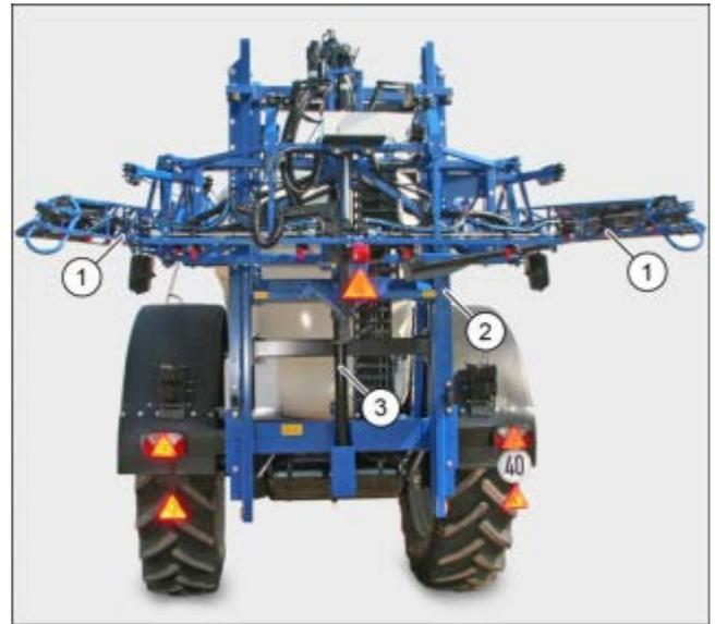
**Abb. 55 Spritzgestänge eingeklappt (Transportstellung)**
