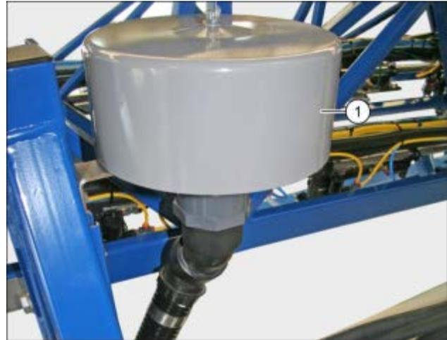
Abb. 93 Luftfilter für Kompressor
