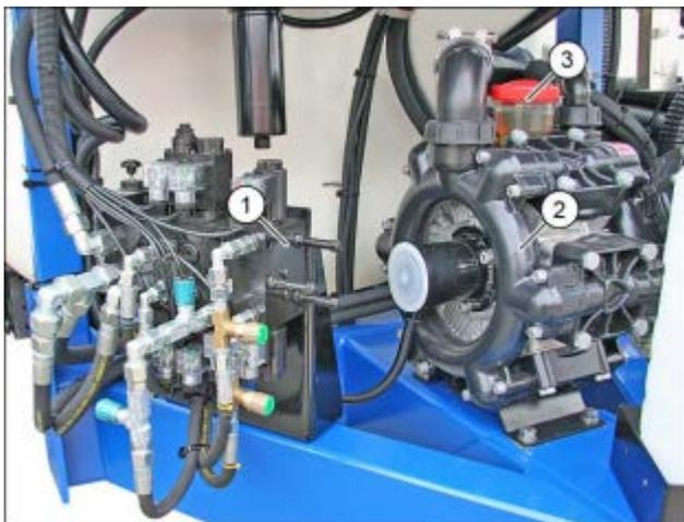
Abb. 46 Spritzmittelpumpe (Spritzpumpe) mit hydraulischem Antrieb
