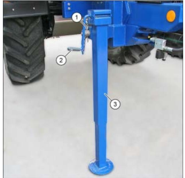
**Abb. 36 Stützfuß mechanisch ausklappbar**
