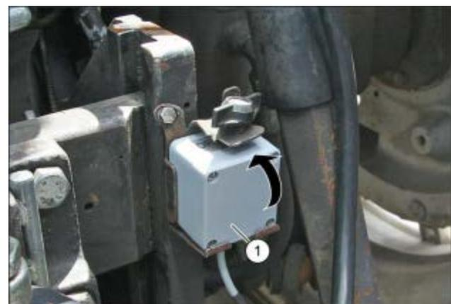
Abb. 88 Gyroscope für Trail-Control
