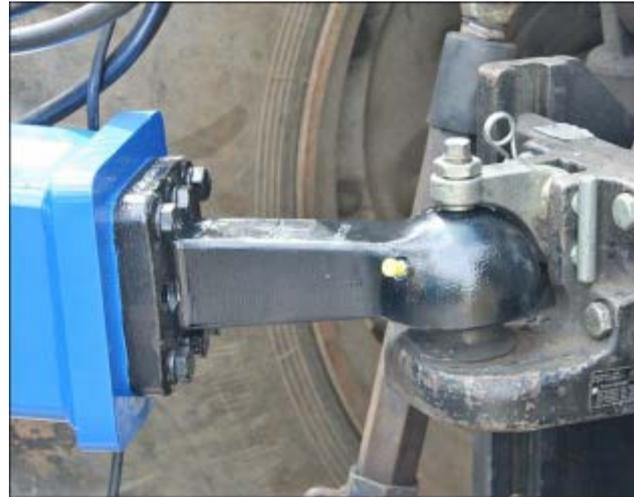
Abb. 33 Zugdeichsel mit Kugelkopf-Kupplung K80 (Option)
