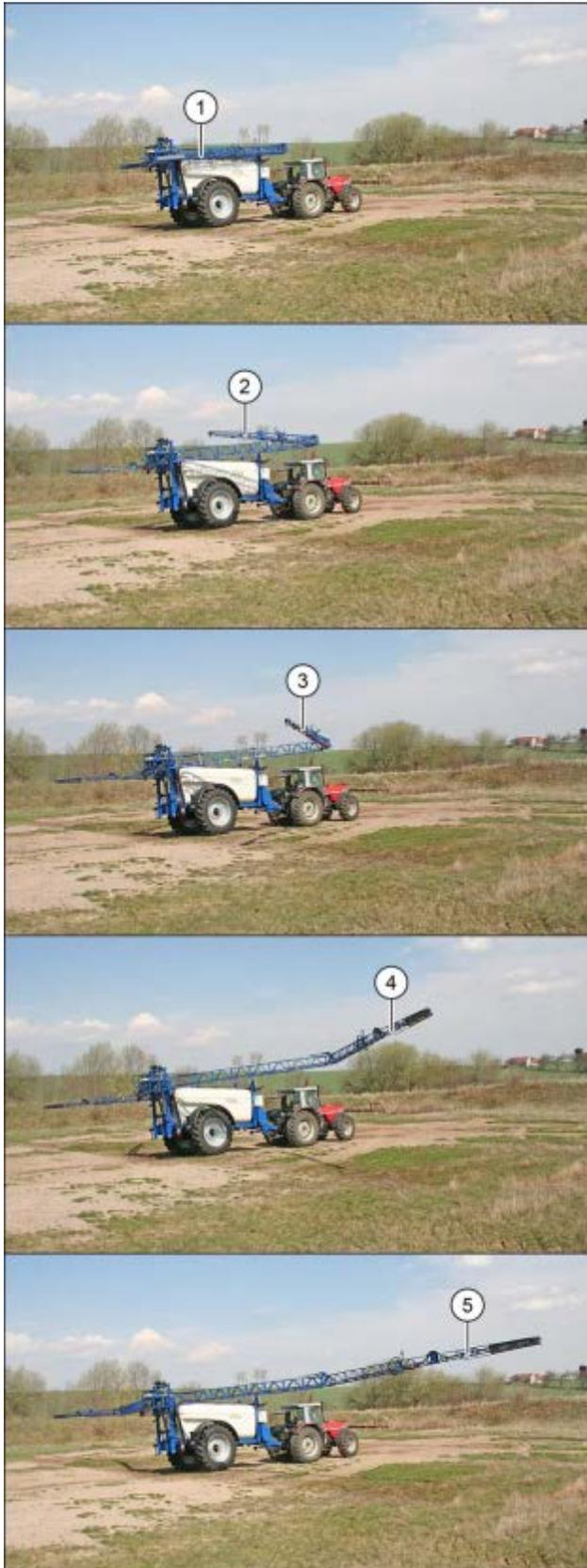
**Abb. 54 Spritzgestänge klappt aus**
