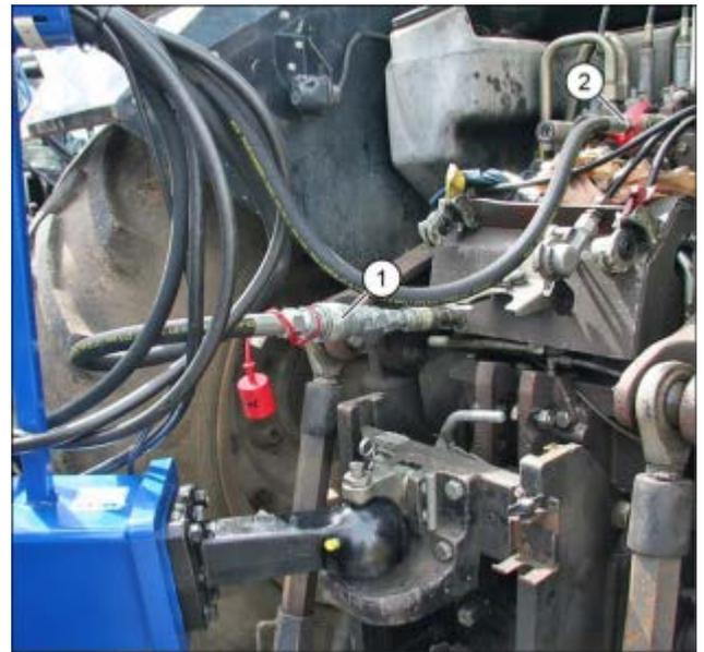
**Abb. 65 Hydraulik-Anschlüsse an Zugmaschine**
