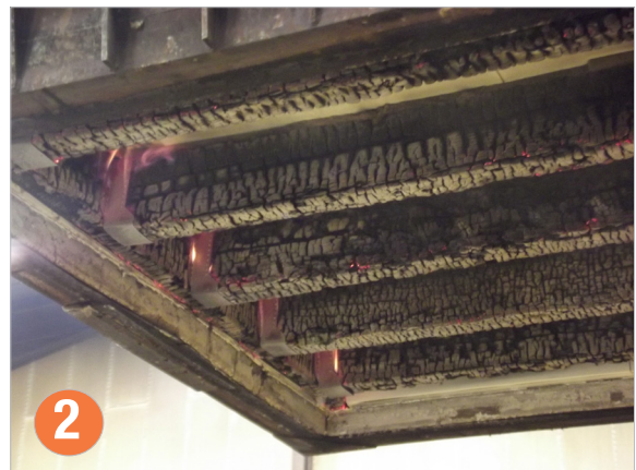
2 Abheben des Deckenbalkenelementes von der Brennkammer unmittelbar nach dem Versuch
