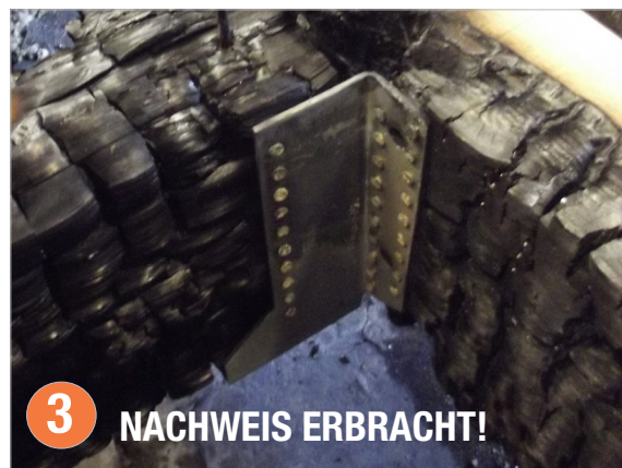
2 Abheben des Deckenbalkenelementes von der Brennkammer unmittelbar nach dem Versuch
