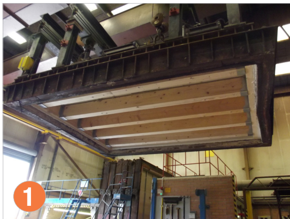
1 Einheben eines Deckenbalkenelementes auf die Brennkammer
