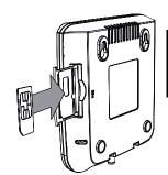
tig wieder in die Führungsschienen des XSJackT3 ein. Die Mulde für die SIM-Karte muss dabei in Richtung des Gehäusebodens des Gerätes zeigen.
