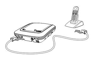
**Hinweis:** Alle angeschlossenen Geräte müssen das Mehrfrequenzwahlverfahren (MFV, DTMF) unterstützen. Modems für Datenverbindungen können nicht an den XSJackT3 angeschlossen werden.
