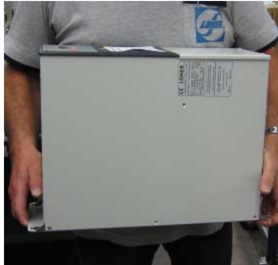
Kompaktgeräte heben - richtig
