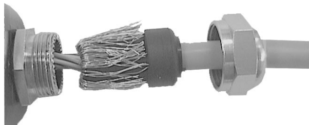
Bild 31: Schirm in der Kabelverschraubung des Gebers auflegen
